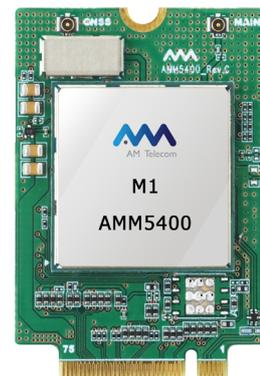
AM Telecomは クアルコム(MDM9206)チップセットを搭載して3GPPのRelease13をベースとするCategoryM1(LTE-M)をサポートするAML540/AMM5400を開発しました。これにより、今後急速に広がっていくLPWA(Low Power Wide Area)を使った様々な産業分野における低価格で低消費電力のIoTサービスの実現をサポートしていきます。
